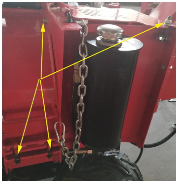
Ao retirar os 4 pernos, poderá abrir a câmara para verificar o estado das lâminas e ventiladores.
