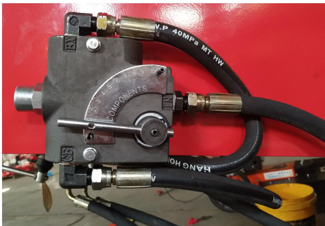
Con la barra se puede ajustar la velocidad de rotación del rodillo de alimentación (desde 0-600rpm).
